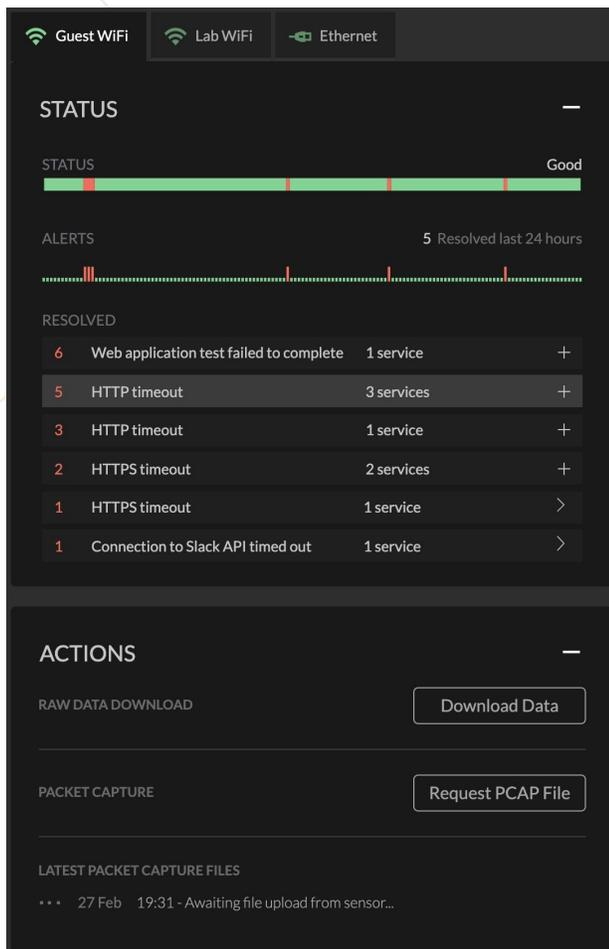
在检测到问题时，UXI传感器会进行动态抓包，并上传到云端。抓包数据非常有用，无需到达现场，就能深入排除问题，并找出根本原因。报告的数据包括：连接、吞吐量、延迟、抖动、丢包、Web服务器响应时间、Web应用程序的会话处理时间和VoIP MoS。
